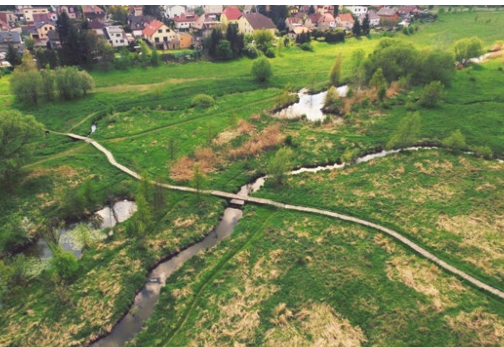
Suchý poldr „Čihadla“. Revitalizace krajiny spočívala v zasypání starých napřímených koryt a nahrazení novými, přírodě blízkými, mělkými, meandrujícími toky. Vznikly malé rybníky, jejichž břehy byly upraveny tak, aby umožňovaly co nejlepší rozvoj fauny a flóry. FOTO: WWW.PRAHA-PRIRODA.CZ, OCP MHMP
