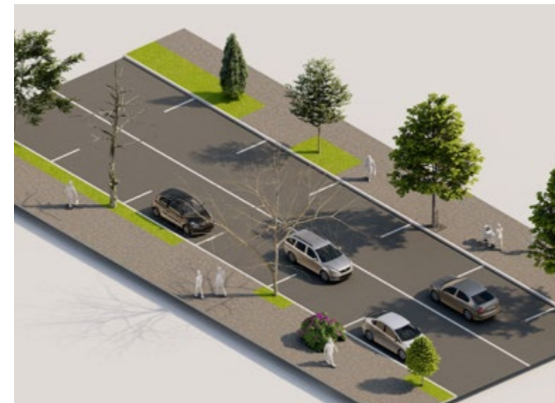
Při výsadbě stromů byla běžnou praxí jejich izolace a zanechání minimálního prostoru pro kořenový systém (vlevo). Výsadba v pásech se záhony naproti tomu zajišťuje stromům lepší závlahu a více prostoru a také lépe dotváří prostor ulice. ILUSTRACE: JAKUB CIGLER ARCHITEKTI
