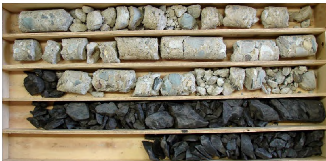
Obr. 9: Mezerovitý a málo soudržný beton základu pilíře klenbového mostu a skalní podloží
